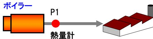
**【例 2】供給を受けた熱量 (P1) をモニタリングする場合 (外部熱源への転換等)**
